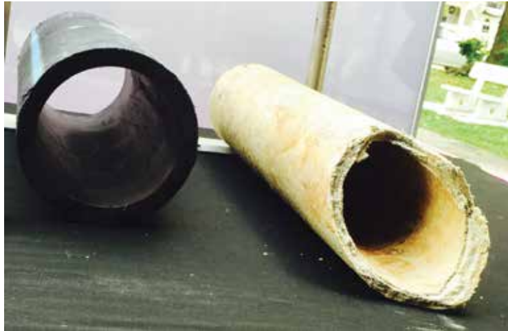
PAIP Polietilina Ketumpatan Tinggi yang baharu (kiri) dan Simen Asbestos yang usang
